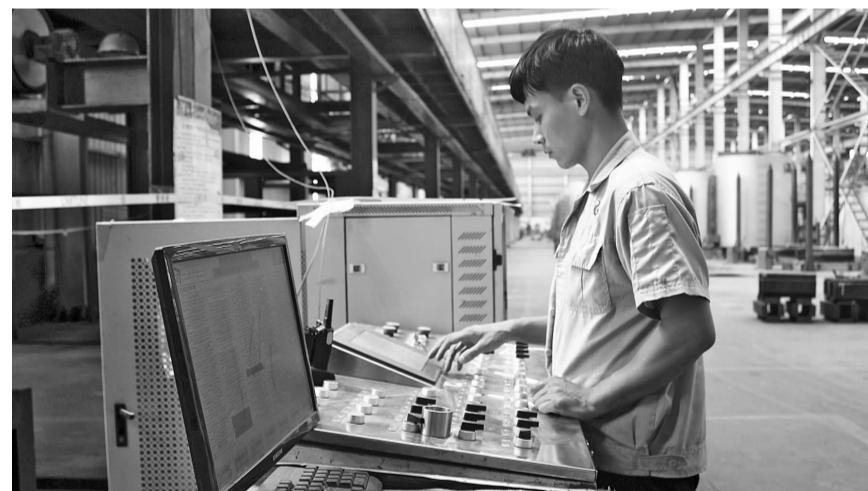
▲9月12日,在山东华驰变压器股份有限公司硅钢生产车间内,一位工作人员正在操作平整拉伸装置。“我们公司的硅钢项目与中国工程院王一德院士合作,突破了低温高磁感取向硅钢制造工艺关键技术,探索出一条新型高性能取向电工钢生产工艺路线,技术国内领先、国际先进。”公司负责人告诉记者,公司的另一个新旧动能转换项目是非晶合金带材项目,与中国科学院都有院士合作,采用冷却速率达每秒100万摄氏度的超急冷凝固技术,与一般冷轧金属薄带的制造工艺相比可降低生产能耗约80%,被称为是冶金材料的一项革命,成为国内外材料科学界的研究开发重点。记者 马源 劲 摄
